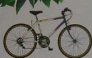
EXPLORER (24 M 46) Les fondus du hors-piste vont apprécier l'EXPLORER. Cadre VTT, fourche Shimano, jantes durul de 24", 18 vitesses indexées, freins cantilever.
